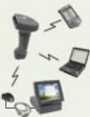
Direkte Kommunikation mit Bluetooth™ fähigen Geräten wie z.B.: PDA oder Notebook; über Basisstation mit jedem beliebigen Computer über Keyboard oder RS232-Schnittstelle.
