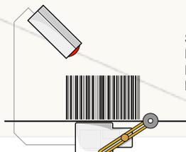
Scanneraktivierung per RS232-Kommando, z.B. per Endschalter in automatisierten Prozessen.
