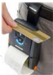
Designed für den schnellen Zugriff via Gürtelclip lässt sich der Bixolon SPP R200 durch seine 13x8 Zentimeter auch wie ein PDA problemlos in Jacken- und Hosentasche verstauen.
