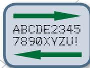
Bi-Direktionales Drucken (Druckkopf druckt auch bei der „Rückwärts-Bewegung“) steigert die Druckgeschwindigkeit auf bis zu 8,9 Zeilen / Sekunde – im Vergleich zu nur 6 Zeilen / Sekunde beim Epson TM-U220.
