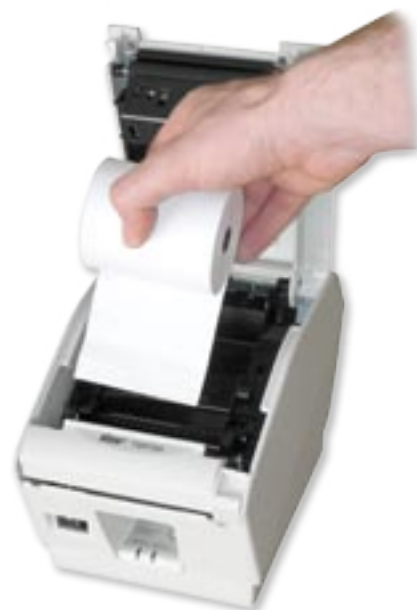
„Drop-In-&-Print“ - System für einfaches und schnelles Wechseln des Bonpapiers.
