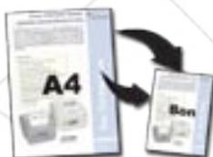
Druckertreiber ermöglicht das Drucken von A4-Dokumenten durch automatische Skalierung auf die Breite des Bonpapiers.
