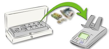
Einfacher, sicherer und benutzerfreundlicher Zählvorgang: Alle Münzen, Scheine, Münzrollen und Gutscheine werden in einer definierten Reihenfolge auf die Tellermate TY<sup>+</sup> Geldwaage gelegt. Das Gerät ermittelt anhand des Gewichtes den exakten Wert und summiert diesen automatisch auf. Der Benutzer muss lediglich zum Starten und Beenden des Zählvorgangs einen Knopf drücken.
