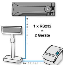
Das RS232-Modell ermöglicht den Anschluss vom Bondrukker an das Kundendisplay, Daten für den Drucker werden „durchgeschleift“. So wird für beide Geräte am Computer nur eine RS232-Schnittstelle belegt.
