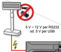
Die Stromversorgung vom Kundendisplay kann ohne Netzteil über den Computer per RS232 oder USB erfolgen. Die Kosten für das Netzteil können so eingespart werden.
