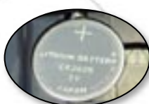
wiederaufladbare Lithium Backup-Batterie für hohe Datensicherheit
